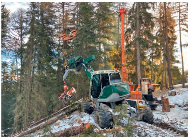
Menzi Muck 545 et processeur, câble grue 3t MM, débardage mécanisé, Thyon 2000
