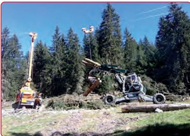
Forêt du Bajin, station avale du câble grue avec façonnage des bois mécanisé (processeur)
